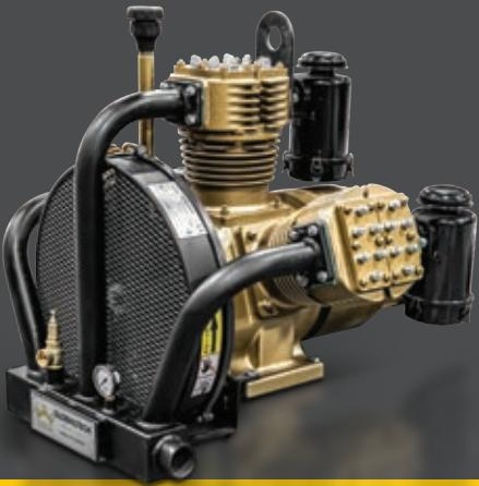
يجب فحص مستوى الزيت بانتظام في كل مرة قبل بدء تشغيل كمبروسر. يجب أن يكون مستوى الزيت عند مستوى النقطة تتحقق من مستوى الزيت في كمبروسر، الحد الأقصى لكمية الزيت هو ٢.٥ لتر، الحمراء على زجاج القياس. قد يحدث تلف دائم في الآلات التي تعمل عند أدنى مستوى للزيت.
